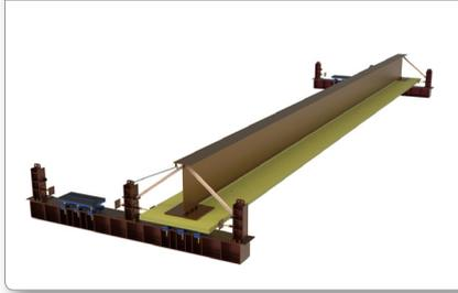
STEP 3 \_ 철근 조립 및 쉬스관 설치
